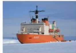
南極観測船「しらせ」 氷厚約1.5mの平坦氷海域を3ノット(時速約5km)で連続砕氷航行が可能な砕氷船です。
