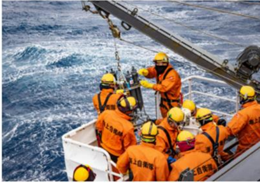
CTD-RMS観測:採水システム付き水温・塩分・圧力による深度測定装置による観測の様子 (提供:国立極地研究所)
