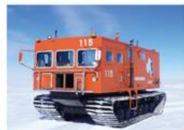
雪上車 大陸氷床における人員や物資の輸送に使用します。
