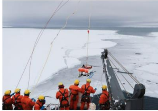
ROV(Remotely Operated Vehicle:遠隔操作型有索無人探査機)による観測の様子 (提供:国立極地研究所)
